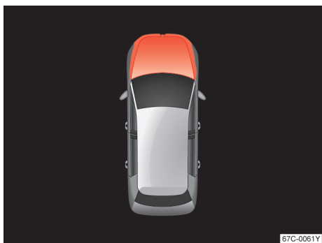
图 13 在组合仪表的显示屏上：发动机舱盖打开或未正确关闭
