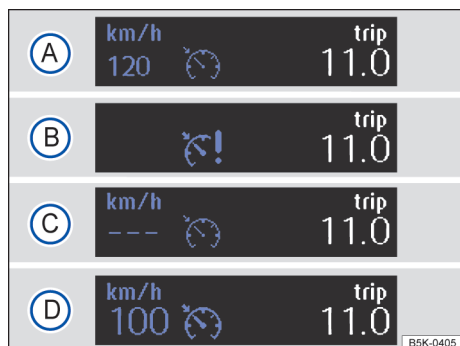
图 91 组合仪表显示屏：定速巡航系统状态显示
